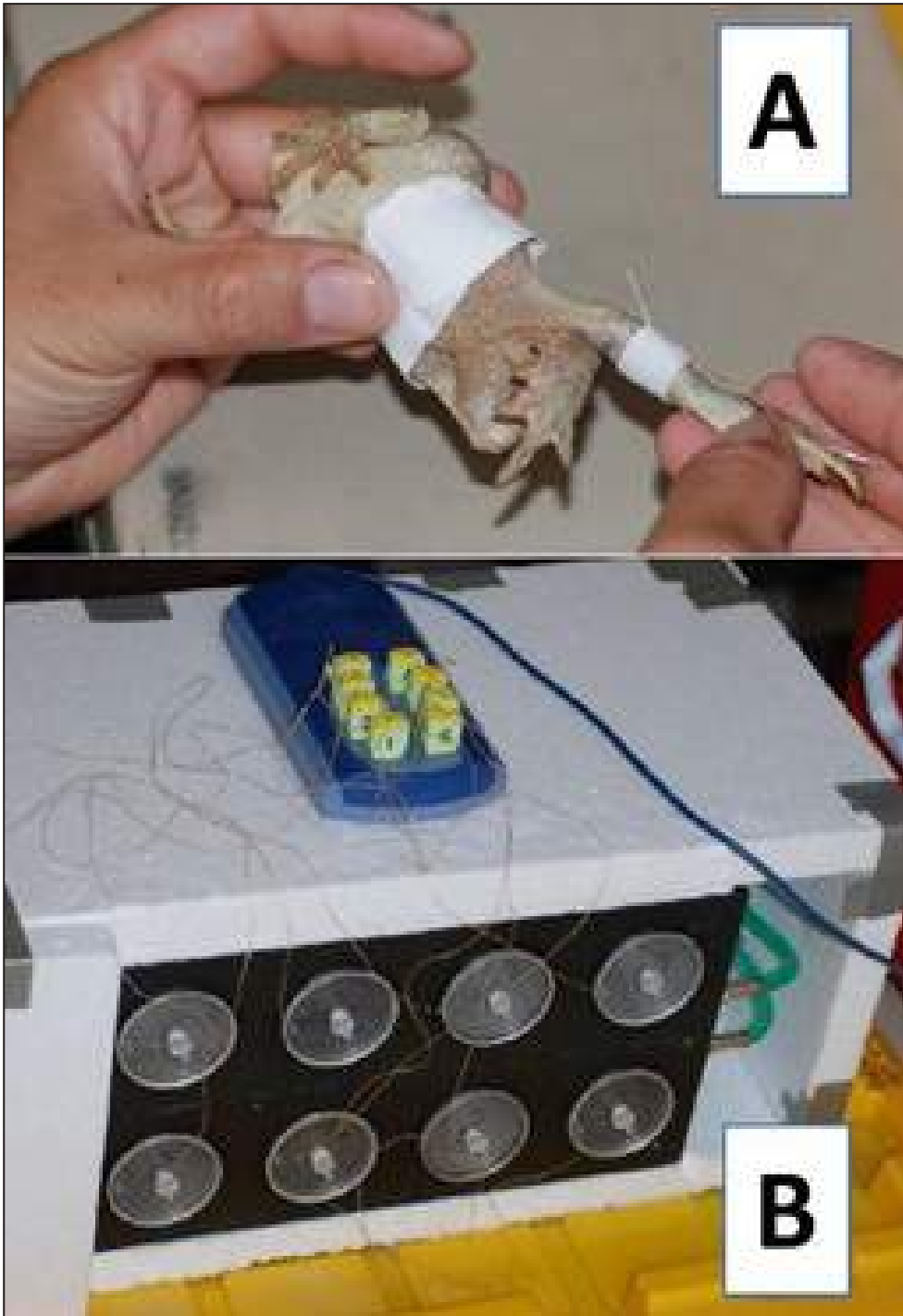
Figura 4.7.10. Equipamiento utilizado para determinar las temperaturas críticas mínimas y punto de cristalización. A) Forma de anclar la termocupla para evitar gérmenes de cristalización. B) Cámaras para la disminución de la temperaturas. Las mismas permiten ver los ejemplares a medida que la temperatura disminuye y evaluar su condición (39) . Foto: E. Sanabria.
